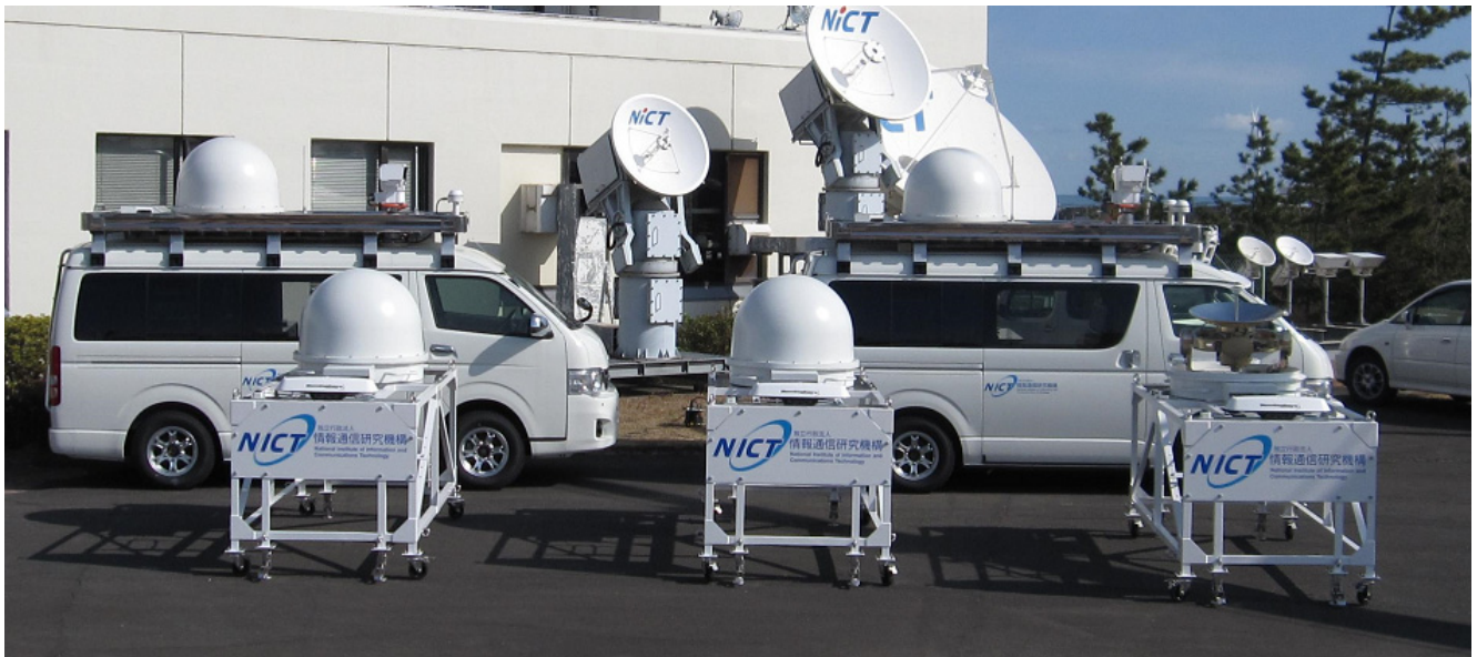
▲移動体地球局(車載局、奥2台)と船舶搭載用アンテナターミナル(船舶架台、手前3台)
