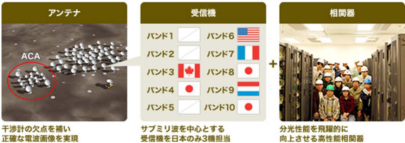
▲ 左: ALMAアンテナ群のイメージ(ACA: Atacama Compact Array日本担当部分、右方のアンテナ群は欧米担当のMain Array), 中: 超低温低雑音受信機の各国分担表 右: 日本が担当したACA相関器 (国立天文台のホームページから)
