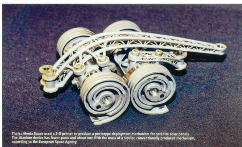
タレス・アレニア・スペース社が 3-D プリンタで製造した衛星ソーラーパネル用の展開機構プロトタイプ。
