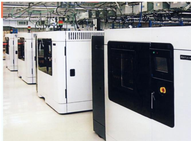
Stratays Direct 社の 3-D プリンタは、熱可塑性樹脂 ULTEM9085 (はじめ多種の材料で製品を作ることができる。Formosat-7 衛星のアンテナ保持機構はこの設備で作られた。(Stratays 社提供)
