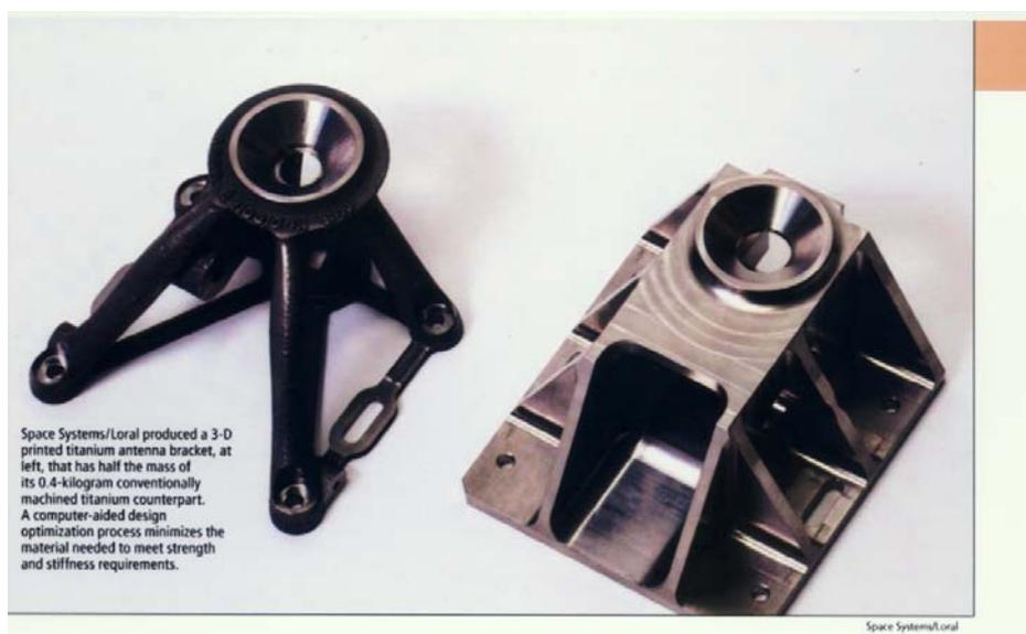
（図左）SS/L社が3-Dプリンタで製造したチタン合金アンテナブラケット。（図右）の従来の機械加工による部品（0.4 kg）より重量が半分となった。（スペース・システムズ・ロラル社提供）
