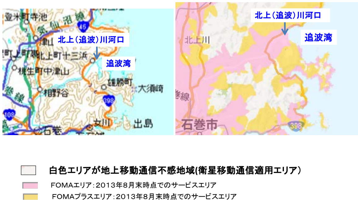
図5 北上(追波)川河口域の移動通信サービスエリア例
