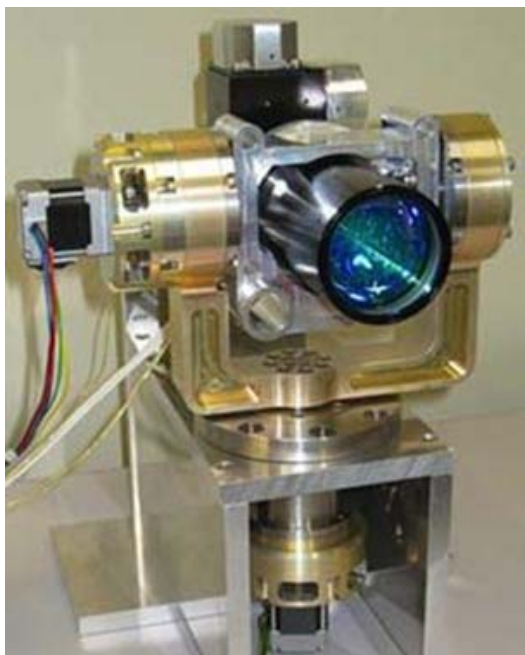
図2 SOTAのEngineering Model (EM) 光学部
