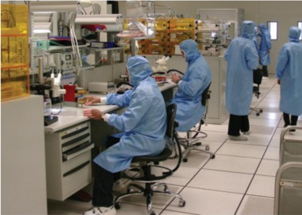
このThales製造工場で製造される進行波管のようなデバイス製造のためのクリーンルーム規格は非常に高い。Credit: Thales Electron Devices
