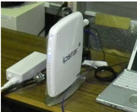
▲ IPSTAR室内ユニット
