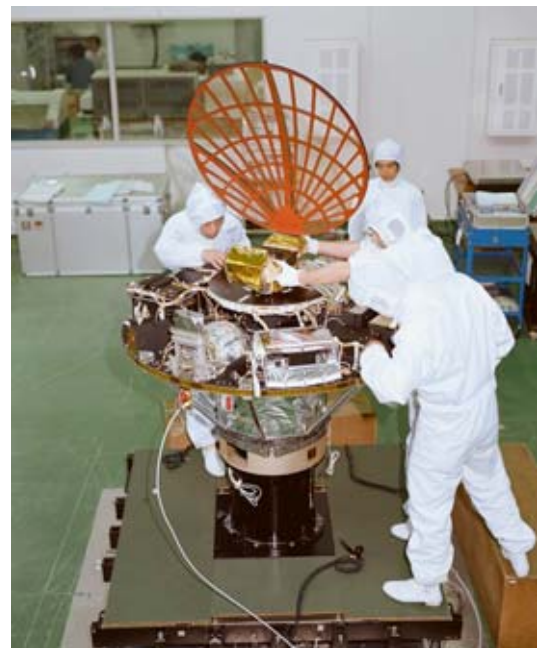
探査機にアンテナを取り付ける総合試験風景
