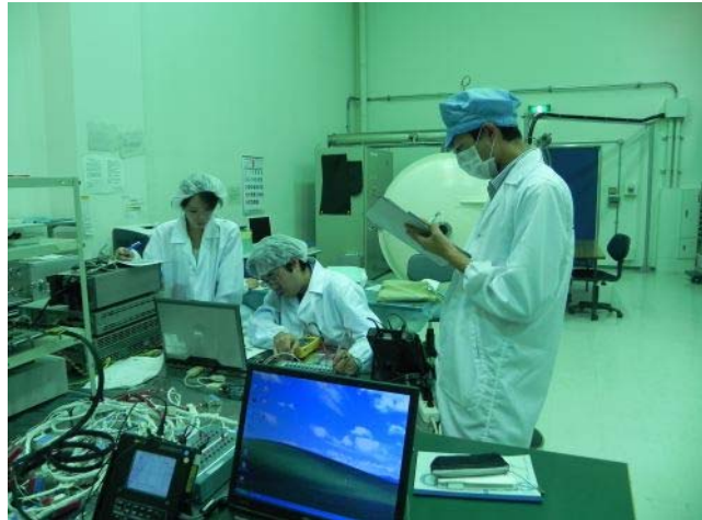
衛星搭載 AIS 受信機と SDS-4 衛星システムとの噛み合わせ試験の様子
