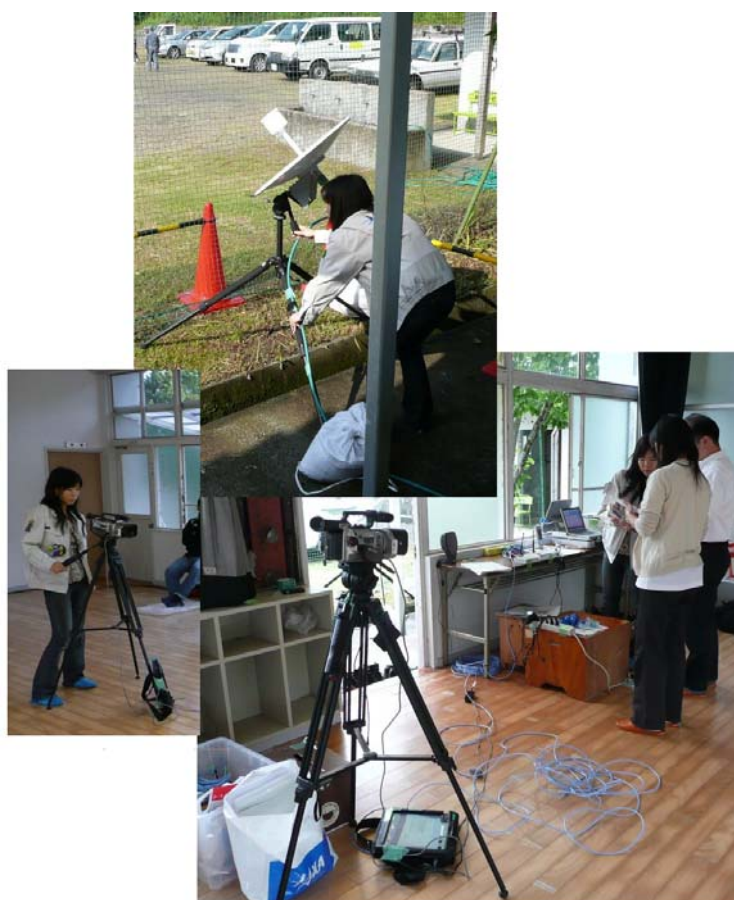
2008年5月 技術試験衛星Ⅷ型「きく8号」(ETS-VIII)を利用した鹿児島県総合避難訓練実験の様子。60cm可搬型アンテナ指向調整(上)、映像を送るカメラの設置(左)、鹿児島市役所の方々に「きく8号」通信端末の使い方をレクチャーする様子(右)
