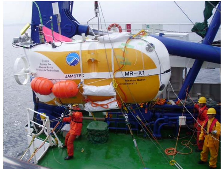
▲ 海中へ投入作業中のAUV
