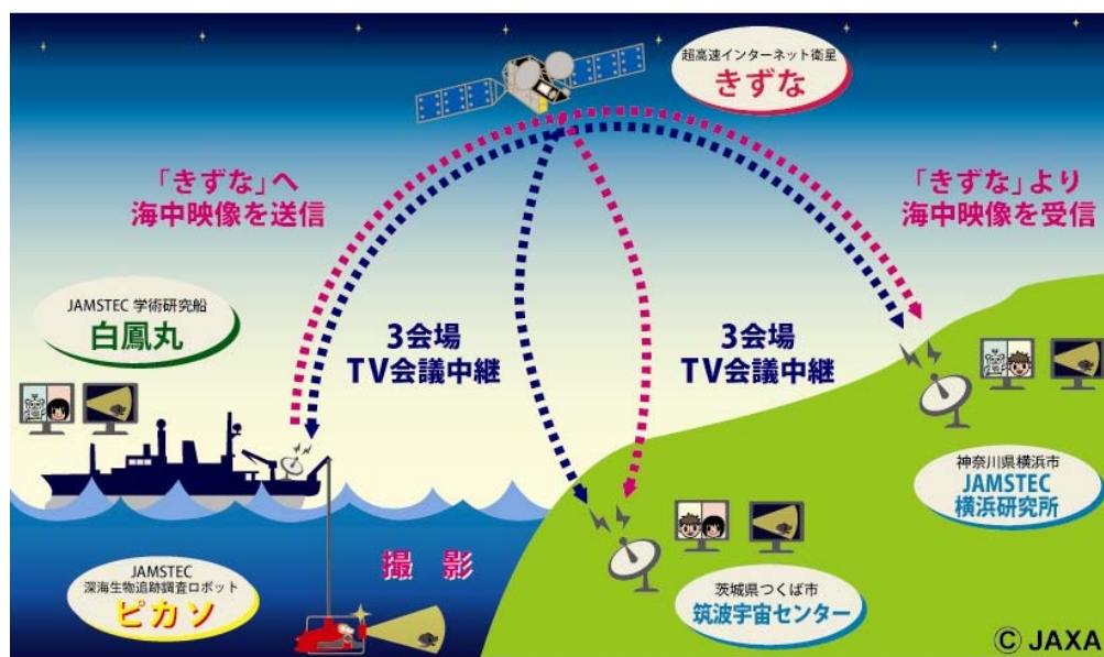
図11 洋上船舶通信実験構成
