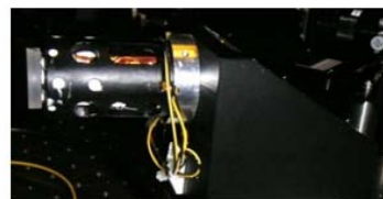
新規に試作した精追尾機構 高速に可動する反射鏡により、大気の影響を被った受信光の伝搬方向を補正する機構。
