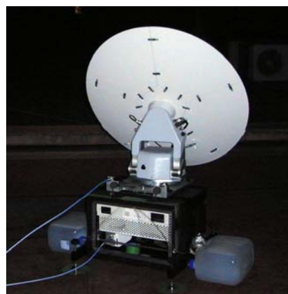
図 2: 可搬型 VSAT のアンテナと ODU
