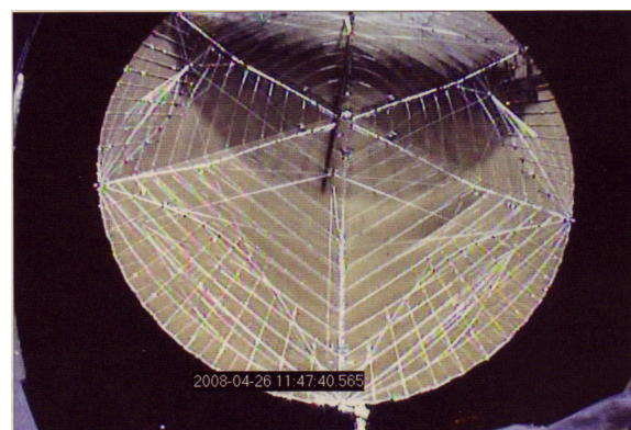
搭載カメラが動画撮影した ICO G1 の 12m アンテナ反射器
