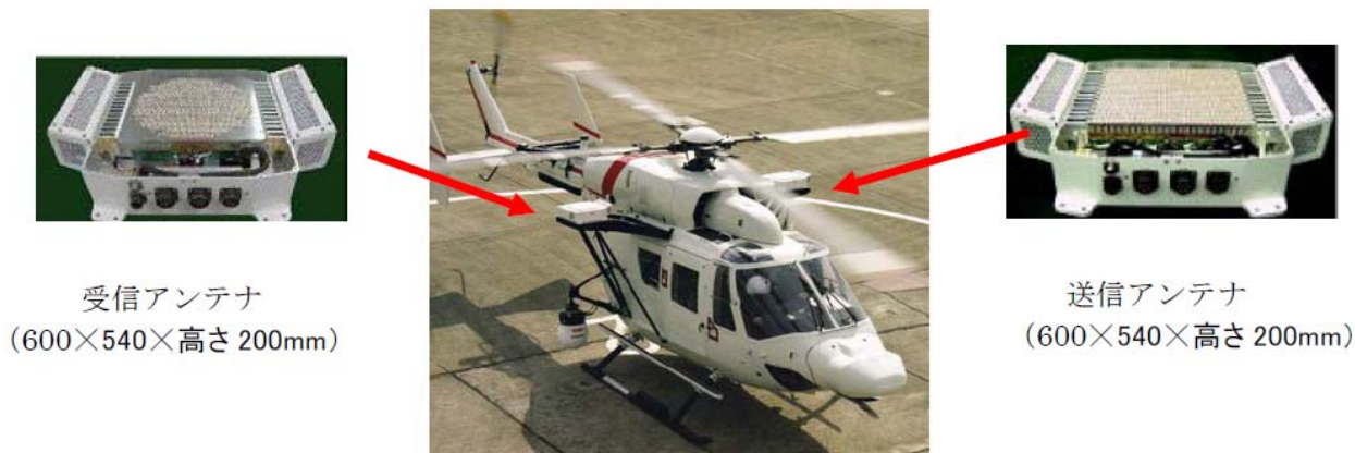
図9 フェーズドアレーアンテナ
