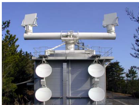
写真 C/Ku帯 可動基線干渉計 アーム長 13m, 反射板 2m×2m 固定アンテナ径 1.8m
