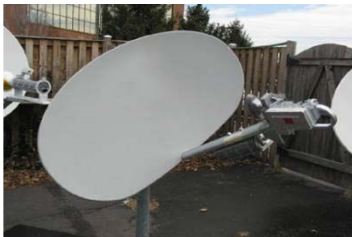
Fig.4 スーパーバード IP-VSAT アンテナ概観 長径 98cm × 短径 56cm (74cm φ 相当)
