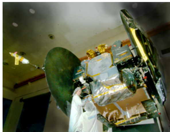
最終熱試験を受ける気象衛星 MTSAT-1R
