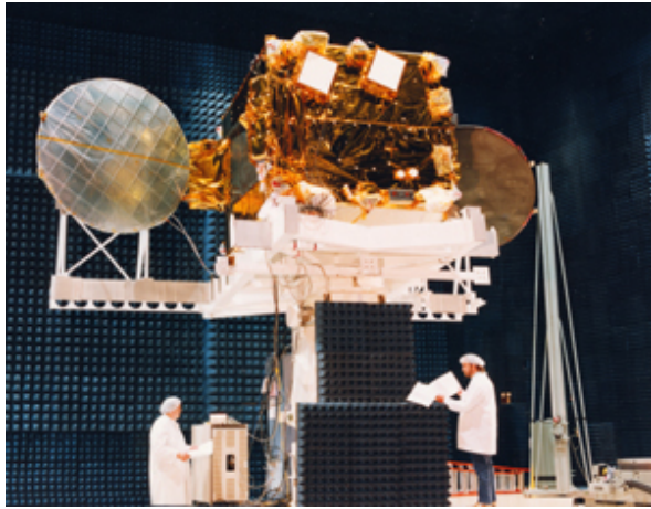
SS/L のコンパクトなアンテナ試験ベンチ内の位置決定装置上の Superbird B
