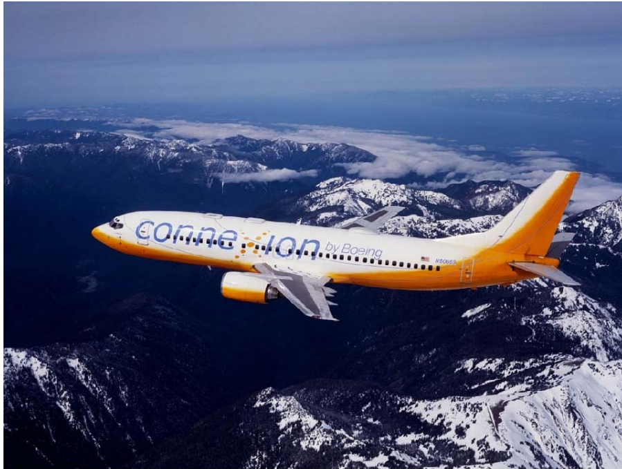
コネクション・バイ・ボーイングのデモ機 “Connexion One”(B737) (機体上部後寄りの楕円形状突起が CBB 用アンテナ)
