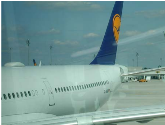
CBB搭載のルフトハンザA340機[機体上部手前の突起がCBB アンテナ]
