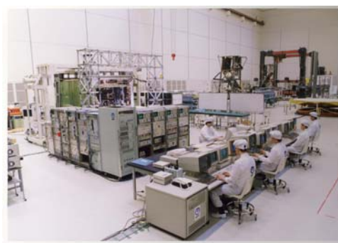
写真2 中継器試験風景 (NTT 衛星研究棟ハイベイ内)
