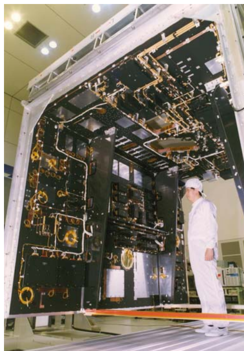
写真1 NTT の搭載中継器 (NTT 横須賀 R&D センタ衛星研究棟)
