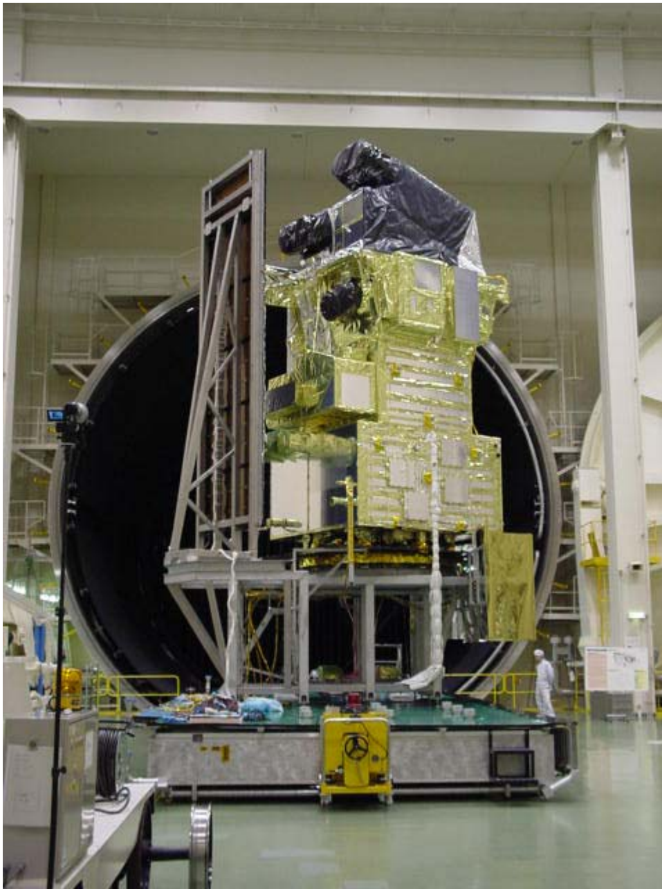
Fig-4 ALOS : 熱真空試験 (JAXA 殿ご提供)
