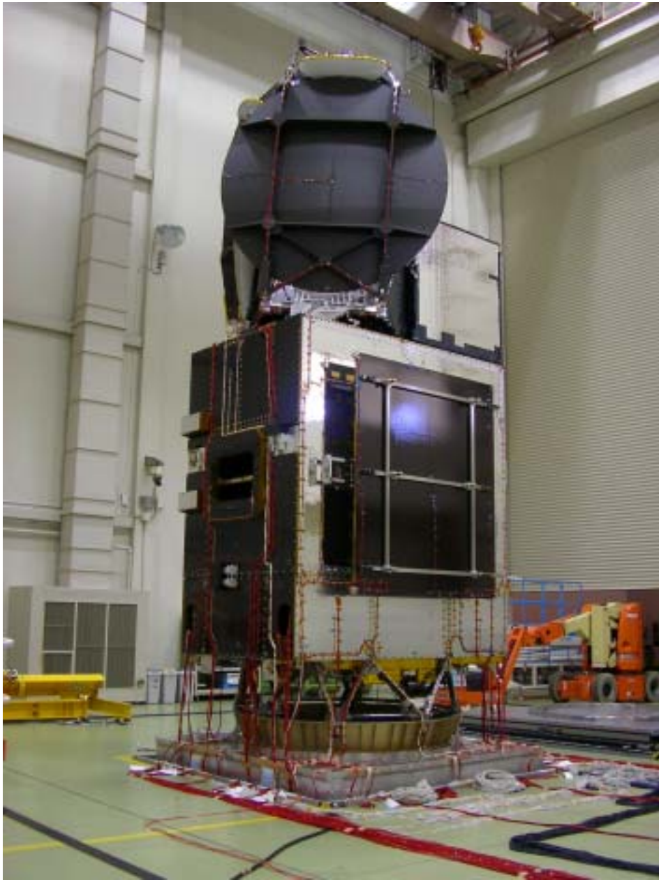
Fig-6 WINDS の振動試験 (JAXA 殿ご提供)
