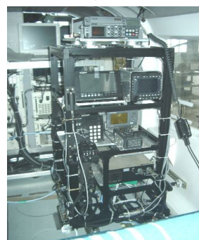
撮影位置特定装置関連ラック (含むカメラ制御、機内の後列)
