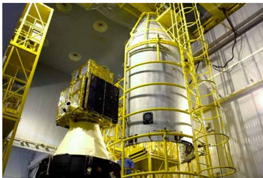
SERVIS 衛星のフェアリング収納作業
