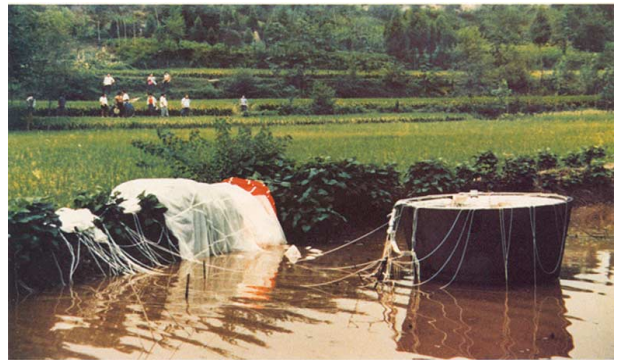
図5 回収型人工衛星が地上に回収された様子。
